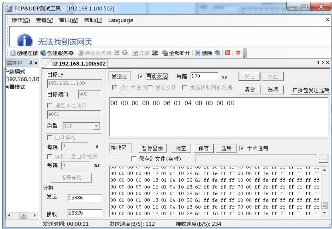
注：响应报文示例中AI0为0x2660，换成有符号数为9824，如果输入是电流，则对应11.992mA（如果输入是电压，则对应2.998V）。AI1~AI7接近为0，对应0mA或0V。
