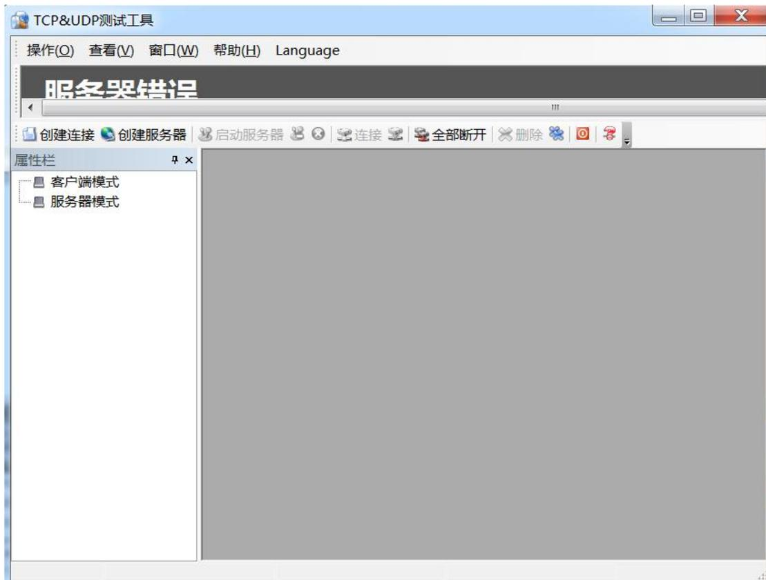
点击创建连接，选择TCP，输入目标IP：192.168.1.100，端口：502，点击创建，创建连接如下：
