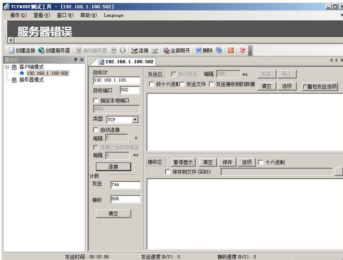
点击连接，发送区勾选按十六进制，在发送窗口输入字节：00 00 00 00 00 06 01 04 00 00 00 08（即通过04功能码读取8路模拟量输入），接收区勾选十六进制，勾选自动发送，接收区返回如下报文时表示连接成功：
