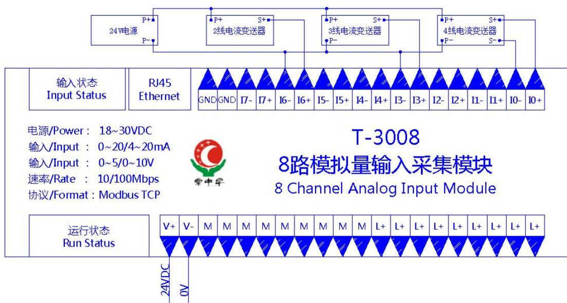
注：出厂默认为 8 路电流输入（即 JP0~JP7 跳线全部短接），如需改成电压输入，请将相应跳线断开。
