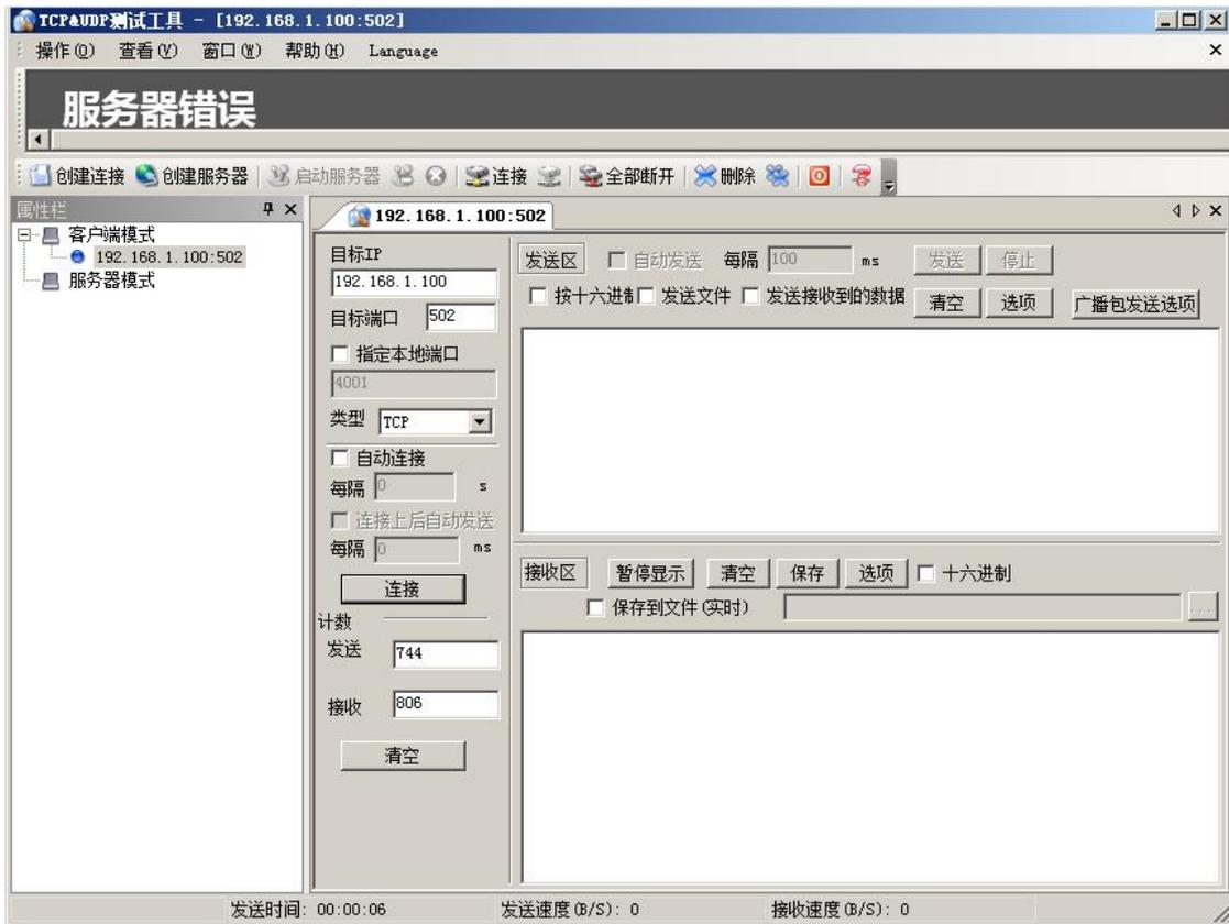
点击连接，发送区勾选按十六进制，在发送窗口输入字节：00 00 00 00 00 17 01 10 00 00 00 08 10 04 E2 09 C4 0E A6 13 88 18 6A 1D 4C 22 2E 27 10，接收区勾选十六进制，点击发送，接收区返回如下报文时表示连接成功：
