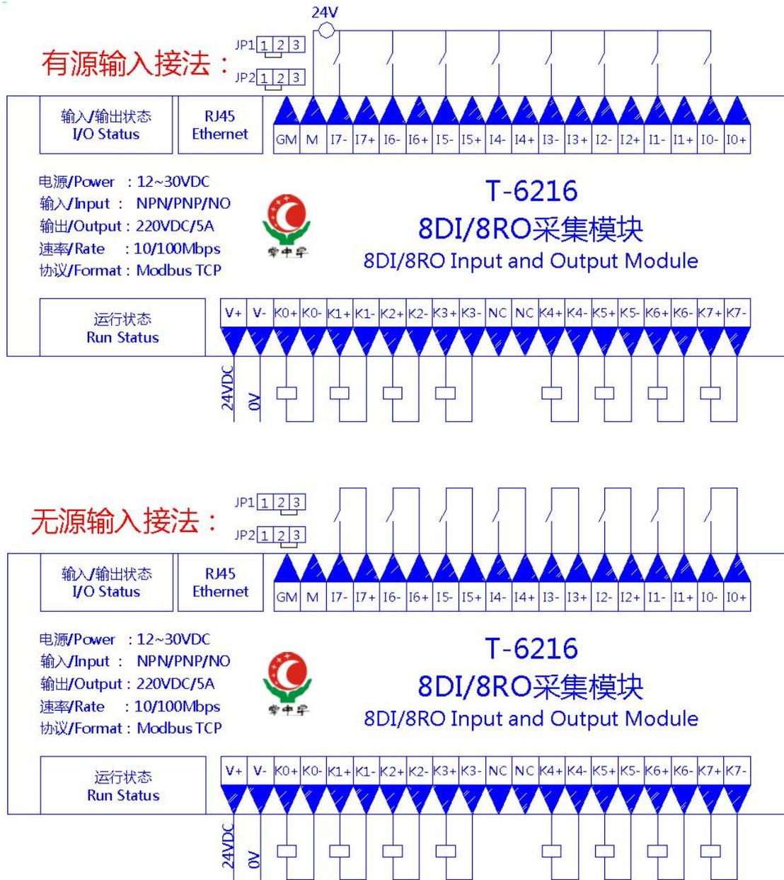
根据现场传感器信号确定接线方式，错误的接线方式将造成模块损坏。
