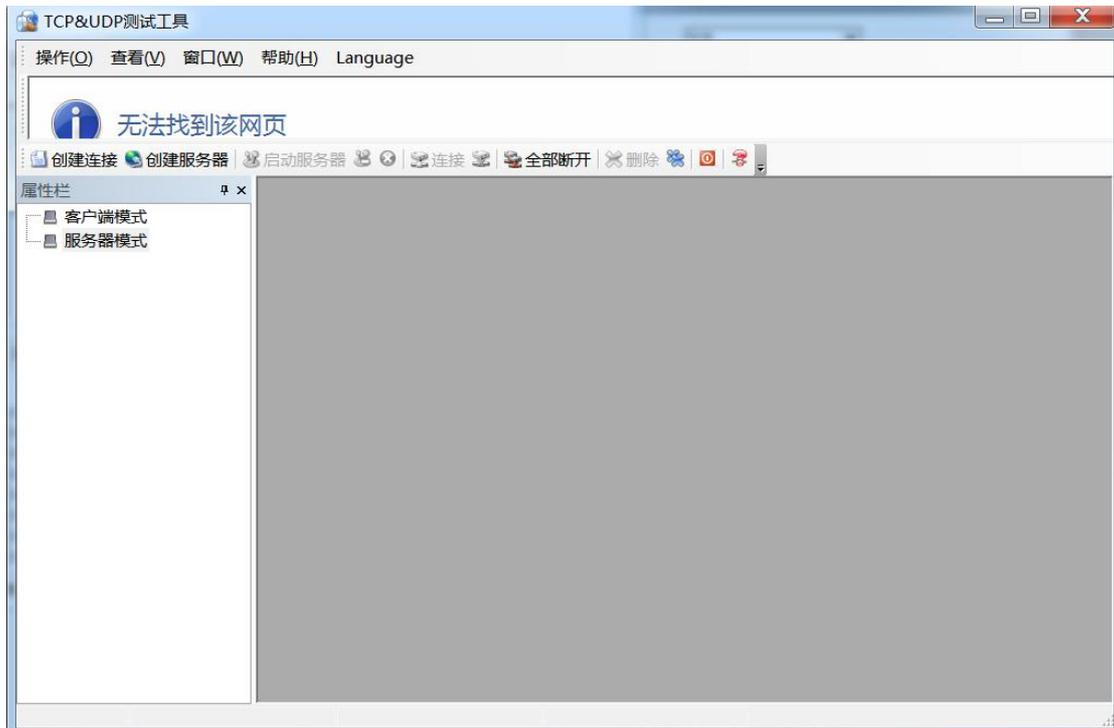
点击创建连接，选择TCP，输入目标IP：192.168.1.100，端口：502，点击创建，创建连接如下：
