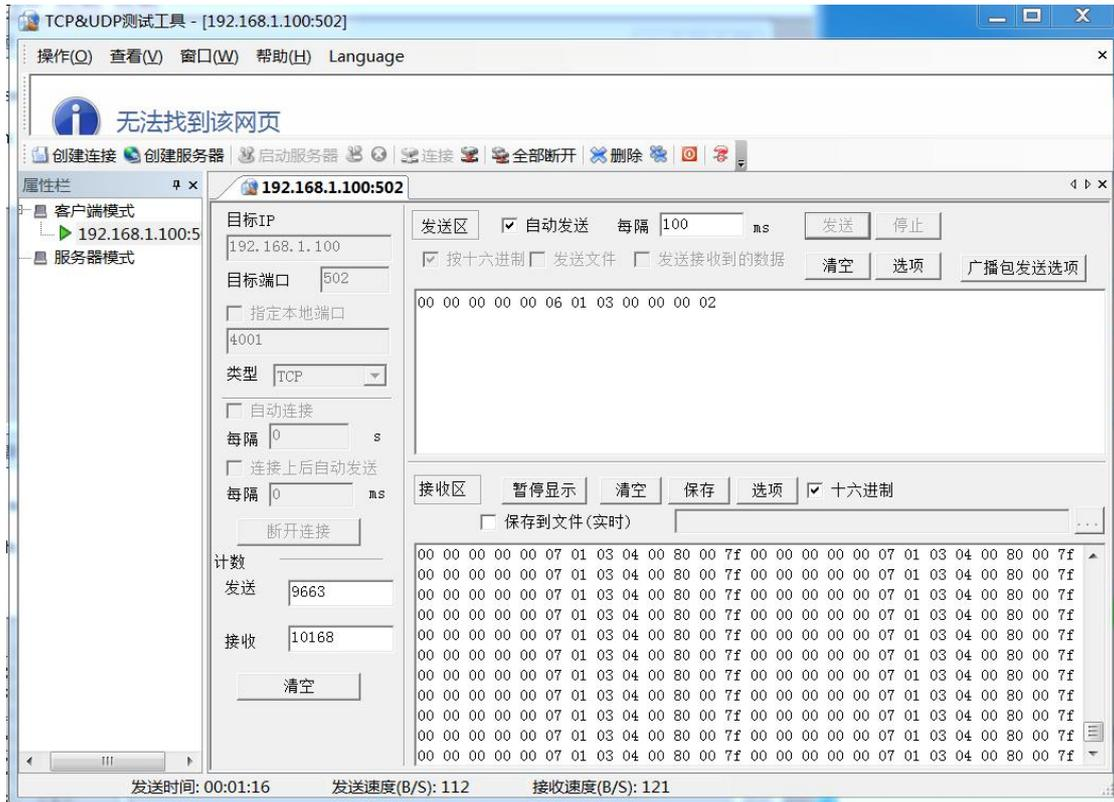
注：03 功能码读取 8 路开关量输入和 8 路开关量输出状态，响应报文高字节在前，低字节在后，即 17 为 1，16~10 为 0，07 为 0，06~00 为 1。
