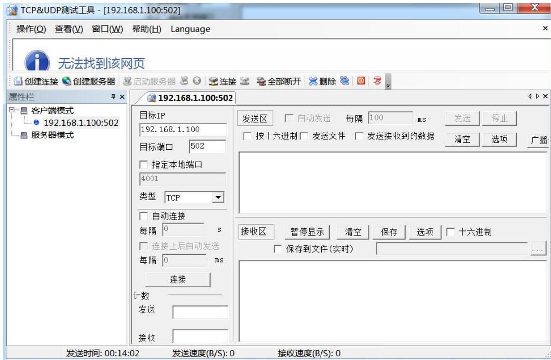
点击连接，发送区勾选按十六进制，在发送窗口输入字节：00 00 00 00 00 06 01 03 00 00 00 02，接收区勾选十六进制，勾选自动发送，接收区返回如下报文时表示连接成功：
