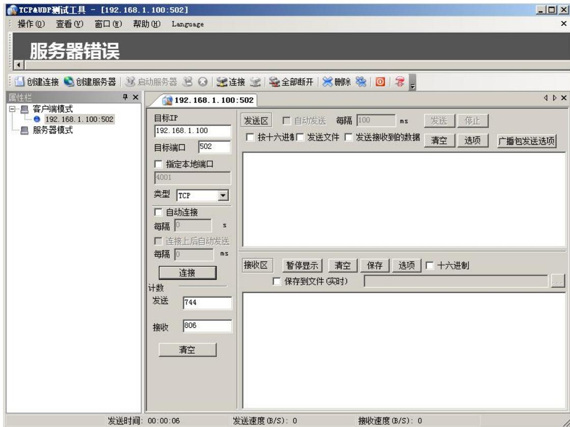
点击连接，发送区勾选按十六进制，在发送窗口输入字节：00 00 00 00 00 06 01 04 00 00 00 10，接收区勾选十六进制，勾选自动发送，接收区返回如下报文时表示连接成功：
